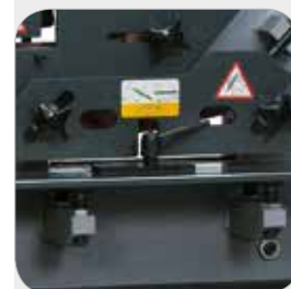
estação de aço plano mesa com batentes angulares e fixadores ajustáveis
