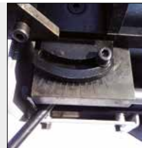
ajuste preciso do ângulo graças a escala
