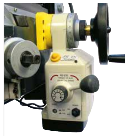
eixo y com regulação contínua
