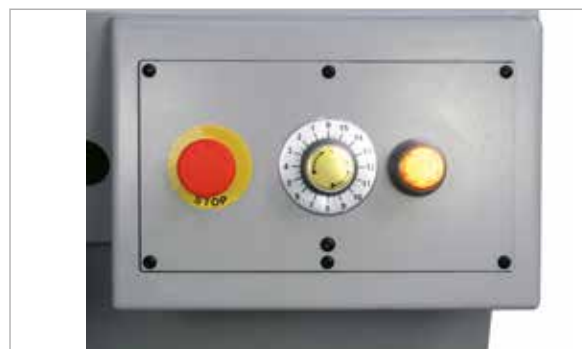
corte semiautomático com paragem automática; regulação manual contínua do hidráulico
