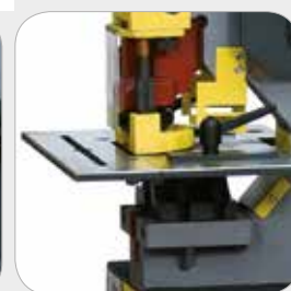
estação de punçonar capacidade máx. 28 x 15mm e 38 x 11mm
