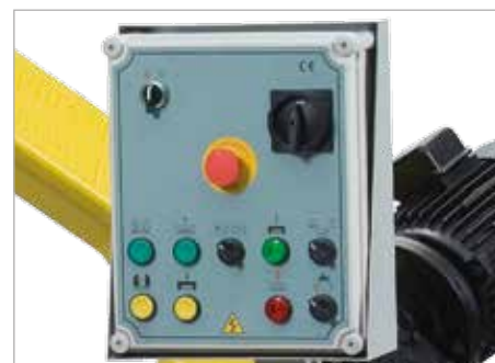
painel controlo da inclinação
