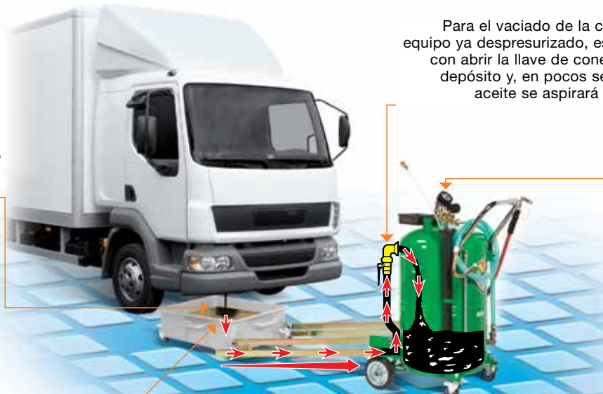
Rejilla/filtro de protección, parasalpicaduras y base de apoyo para filtros
